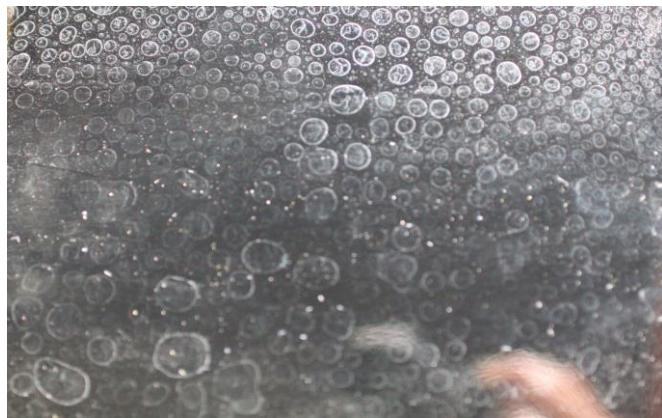
アパタイト被覆二酸化チタンが自己洗浄効果を發揮し、鱗状痕（ウォータースポット）の付着を防止します。またガラスを親水状態に維持し雨天での後方視界を確保します。
